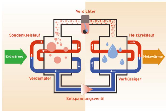
Grafische Darstellung der Funktionsweise der Sole-Wärmepumpe, wie sie bei Erdwärmehetzungssystemen zum Einsatz kommt.
